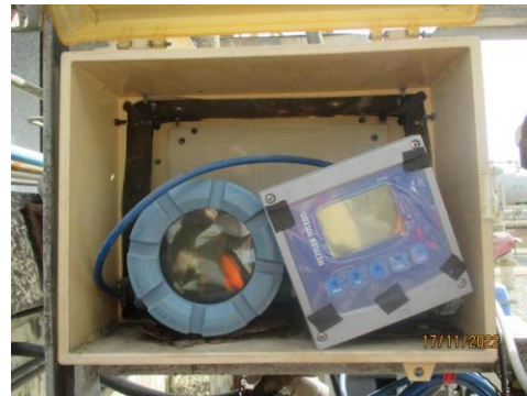
รูปที่ 4 pH-Temp. Meter Online ที่ Cooling Tower
